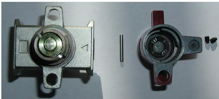
1. PUT SPRING CAP ON TOP OF THE SPRING HOUSED INSIDE THE VALVE BODY
